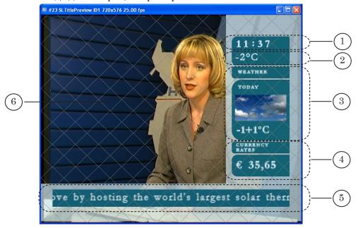
В примере Суап демонстрируется вариант организации наложения титров (1–5) на основной видеоряд (6).
