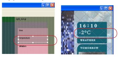
Если во время демонстрации изменить информацию в текстовом файле weather.txt (можно изменять только следующий после «temp:» текст), то в течение некоторого времени (не более 30 с) после сохранения файла эти изменения отобразятся в окне просмотра.
