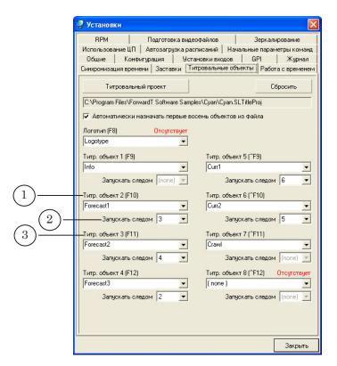
Здесь с помощью выпадающих списков Запускать следом, настраивается нужная последовательность включения показа титровальных объектов. В выпадающем списке Запускать следом (2) выбирается номер титровального объекта (3), который следует включить сразу после выключения титровального объекта, выбранного в соответствующем списке Титровальный объект # (1).
