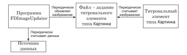
В примере Cyan в качестве источника данных для программы FDImageUpdater используется текстовый файл Weather\weather.txt. Через заданные промежутки времени (в проекте данного примера — 30 с) FDImageUpdater считывает информацию из файла weather.txt и обновляет изображение в файле 40\_160\_bottom.tga, который является заданием для
